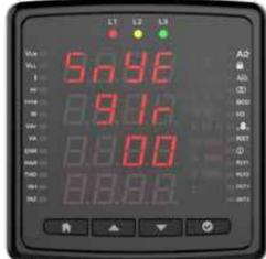
Gerilim trafosu ayarını ile seçip tuşuna basınız. Bu özellik gerilim ölçümü olmayan cihazlarda mevcuttur.
