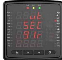
Gerilim trafonuzun sekonder değerini ile giriniz ve tuşuna basınız. Bu özellik gerilim ölçümü olmayan cihazlarda mevcuttur.
