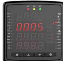
Akım trafonuzun sekonder değerini girmek için tuşuna basınız. Bu özellik akım ölçümü olmayan cihazlarda mevcuttur.
