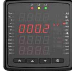
Gerilim trafonuzun sekonder değerini girmek için tuşuna basınız. Bu özellik gerilim ölçümü olmayan cihazlarda mevcuttur.
