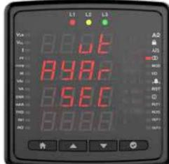
Gerilim trafosu kullanıyorsanız ile on konumuna getirip tuşuna basınız. Bu özellik gerilim ölçümü olmayan cihazlarda mevcuttur.
