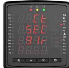
Akım trafonuzun sekonder değerini ile giriniz ve tuşuna basınız. Bu özellik akım ölçümü olmayan cihazlarda mevcuttur.
