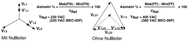
Asymmetrische Phasen führen zu Erhitzung und Leistungsverlust bei Motoren. Die Phasensymmetriegrenzwerte können vom Anwender zwischen 5 und 15 % eingestellt oder deaktiviert werden. Die Hysterese beträgt 30 % des eingestellten Asymmetriewerts. Beispiel: Versorgung mit 3 x 380 V mit 10 % Asymmetrie, Relais schaltet aus bei: 380 - (10 x 400 / 100) = 340 V Relais schaltet ein bei: 380 - ((10 - (10 x 30 %)) x 400 / 100) = 353,2 V
