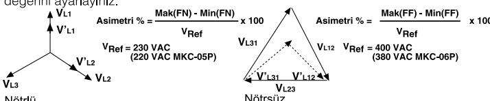
Gerilim dengesizliği motor sorgu sıcaklığının belli bir miktar artmasına ve dolayısıyla motor gücünün düşmesine neden olur.
