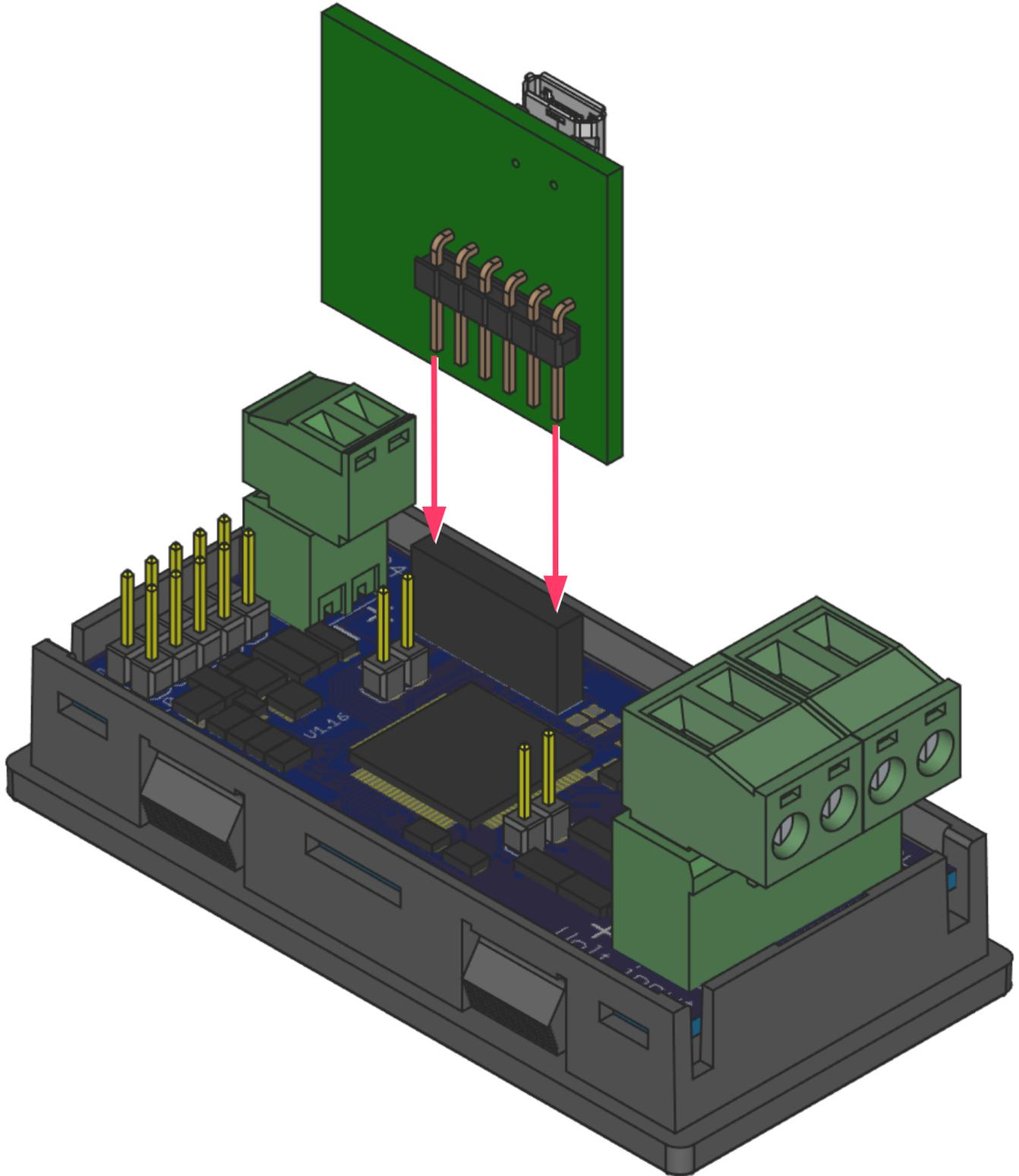
Die USB-Schnittstellenkarte an der in der Grafik gezeigten Position auf die Platine des Digalox® DPM36 aufstecken. Darauf achten, dass alle Pins im Sockel stecken. Zur Verbindung mit dem PC wird ein USB-Kabel mit USB-Micro-B-Stecker benötigt.
